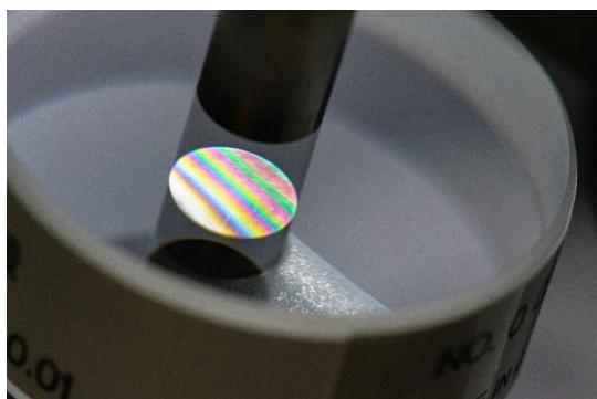
Figur 13: (a) Lysstriber på amboltens overflade på grund af interferens. Forskellige farver fremkommer fordi det indkomne lys er hvidt. (b) Eksempler på interferens striber som fortæller om formen af amboltens flade. Figur lånt fra Mitutoyo materiale [4].
