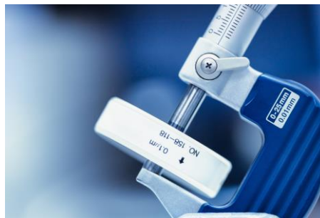
Figur 12: (a) Planglas. (b) Planparallelglas holdes mellem ambolt og målespindel på mikrometerskrue.
