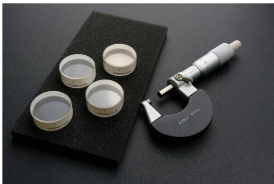
Figur 14: Planparallelglas af forskellig tykkelse til kontrol af mikrometerskrues parallelitet.
