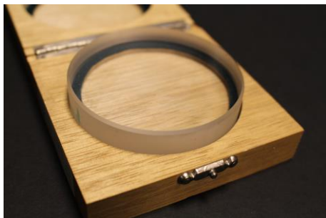
Figur 12: (a) Planglas. (b) Planparallelglas holdes mellem ambolt og målespindel på mikrometerskrue.
