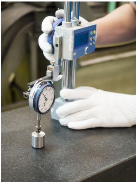
Figur 2: Eksempel på en måling i ét punkt udført med et måleur.
