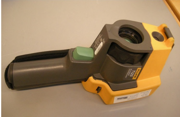
Figur 2. Strålingskamera Ti25 (fabrikat Fluke) til visuel visning af både måleområdet og til punktmåling af overfladetemperaturen. I modsætning til strålingstermometeret vist ved figur 1 er strålingskameraet i stand til også at vise den flade, hvor man i udvalgte punkter kan måle temperaturen ved hjælp af stråling. Kameraet giver altså væsentlig mere information om fladen man måler på. Til gengæld er prisen væsentlig højere end for strålingstermometeret vist ved figur 1. På billedet vender kameraets display ned mod bordet og kan således ikke ses på billedet.
