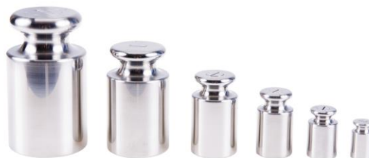
Figur 6: Sæt af lodder med forskellig masse. Lodderne kan bruges som normaler indenfor masse. Det vil sige man kan bruge lodderne til at kalibrere en vægt med.
