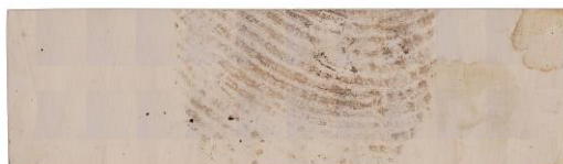
Figur 11: Overfladen af en gaugeblok med et tydeligt fingeraftryk. Klodsens bør rengøres inden den tages i brug. Er dette ikke muligt, vil det være nødvendigt at kassere den og tage en ny klods i brug.
