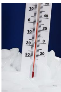
Figur 25: Vand går fra flydende til fast form ved 0 °C (og et tryk 1 atm). Dette kan bruges til at tjekke et termometer for nulpunktsfejl. Termometeret skal vise 0 °C når det sættes ned i et glas med isterninger.
