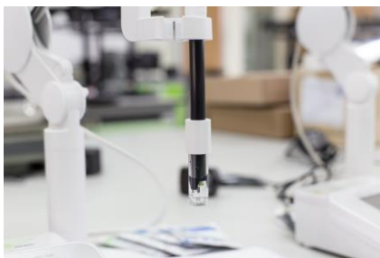
Figur 26: En pH glaselektrode skal kalibreres før brug.
