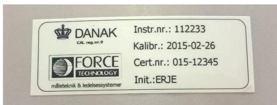
Figur 12: Eksempel på mærkat påsat et instrument efter en akkrediteret kalibrering (Billedet taget 2016-06-24; må dette instrument anvendes?)
