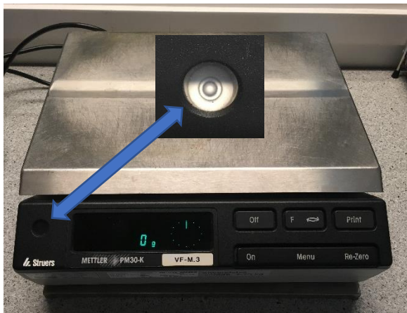
Figur 29 Vægt. Bemærk libellens placering og indstilling.
