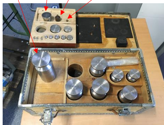
Figur 30 Kalibrerede lodder til kontrol af vægte. 10 kg lodder er størst tilladte uden løftegrej af hensyn til arbejdsmiljø.
