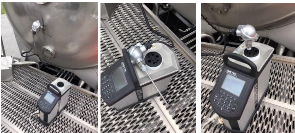
Figur 18 Anvendelse af tørkalibrator. Venstre: PT100 sensor monteret i følerlomme. Midt: PT100 sensor. Højre: PT100 sensor monteret i tørkalibrator. Der anvendes ved denne kalibrering ingen reference.
