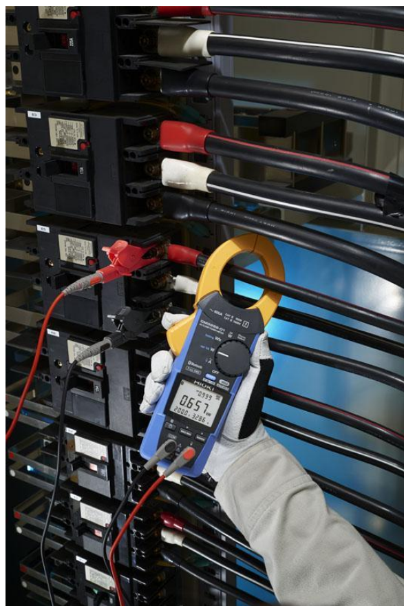
Figur 5. Håndholdt statisk elmåler (fabrikat Hioki, model CM3286). Elmåleren har nederst indgangstilslutninger til at måle spænding og øverst strømtang til at måle strøm. Instrumentet kan måle flere parametre og dette i et større område end den simple elmåler vist ved figur 4, bl.a. spænding, strøm og effekt. Den gule strømtang øverst åbnes ved at påvirke den gule knap til venstre. Den åbne strømtang anbringes rundt om den ledning, i hvilken man vil måle strømmen. Målingen af strømmen foretages, når strømtangen igen er lukket om ledningen.
