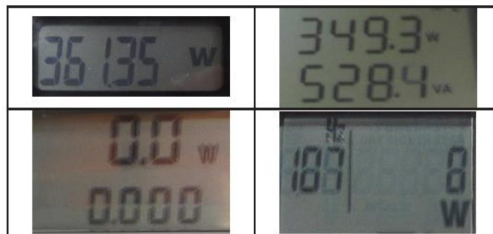
Figur 18. Displayudvisningen fra hver af de fire elmålere. Effekten bestemt af den kalibrerede elmåler er 360 W.
