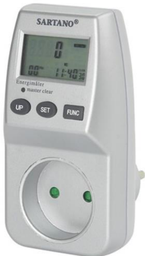
Figur 4. Statisk elmåler (fabrikat Sartano, model EMD-3). Denne type elmåler sættes direkte i lysnetkontakten, og belastningen tilsluttes ved kontakten foran på energimåleren. Herefter kan f.eks. effekten og efter et stykke tid også energien aflæses. Der kan også indkodes en kostpris for hver forbrugt energienhed (kWh), således at en pris for anvendelsen af belastningen kan aflæses.
