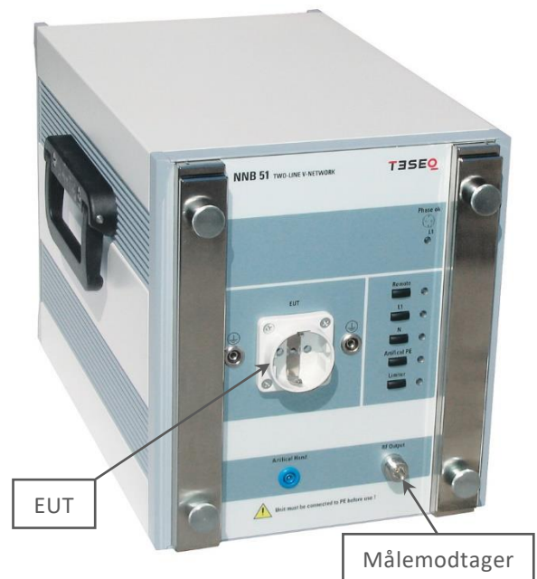
Figur 4. LISN for måling af emission af støjspænding. EUT tilkobles via den hvide stikdåse, og målemodtageren via koaksialstikket. Lysnettet tilkobles på bagsiden af LISN (foto: TESEQ/AMETEK, Inc.).
