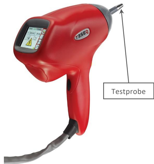
Figur 6. ESD testgenerator med testprobe, hvorfra udladningen sker. Generatoren holdes i hånden, og testproben føres hen til EUT, hvorved udladningen sker (foto: TESEQ/AMETEK, Inc.).
