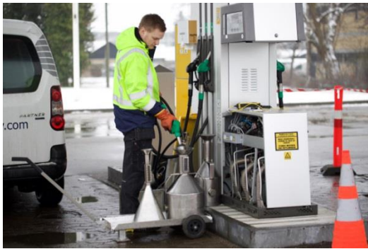
Figur 1: Tankanlæg til tankning af diesel eller benzin. Her kontrolleres om målingen er indenfor tolerancen.
