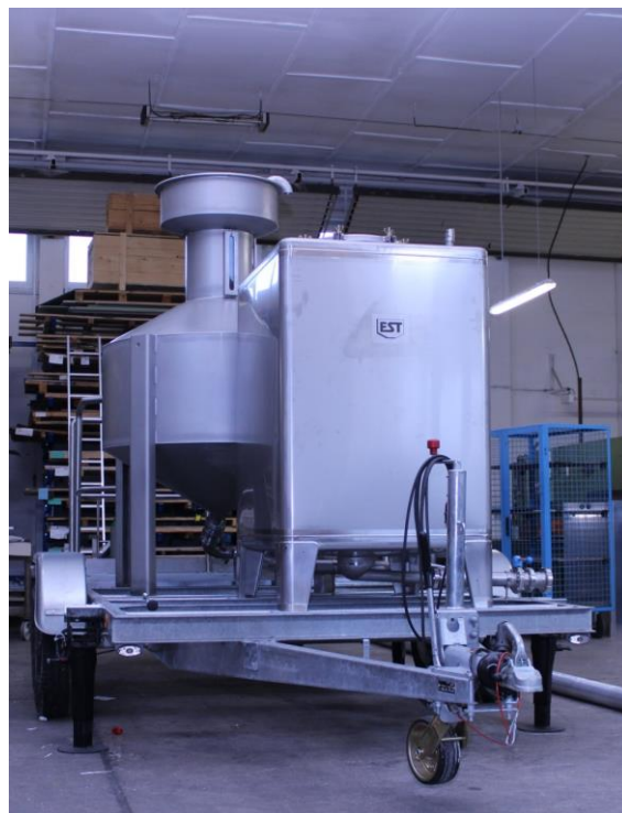
Figur 18: Målevogn til volumetrisk on-site verifikation af flowmålere. Den forreste beholder indeholder pumper og flowreguleringsudstyr. På den bagerste beholder kan det volumetriske indhold aflæses.
