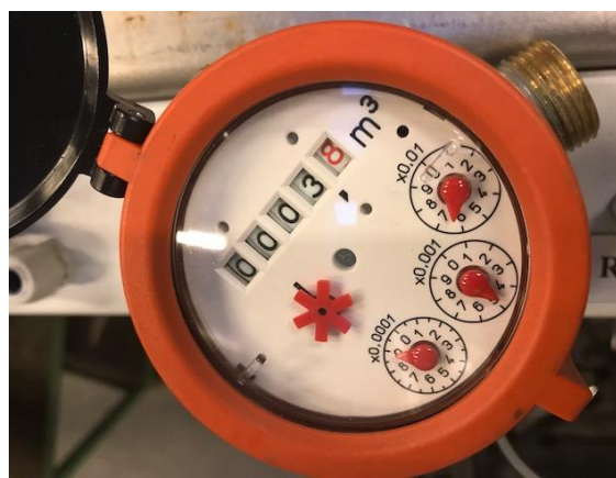
Figur 9: Tællerværk på en vingehjulsåler. Måleren viser kubikmeter, men også faktor 1/10, 1/100, 1/1000 og 1/10000 her af.
