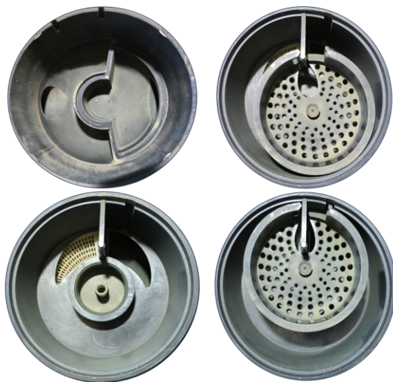
Figur 10: Øverst til venstre: Skallen af måleren, flowretning fra vestre til højre. Nederst til venstre: Afskærmning fra indgang til udgang af måleren med filter i indgangssiden. Til højre: Ringstemplet i to forskellige positioner.
