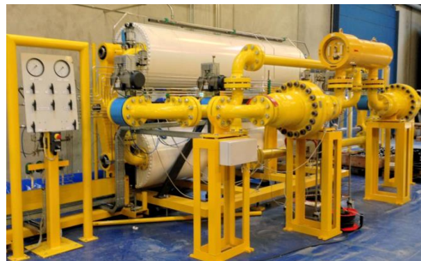
Figur 8 Piston prover til højtryksgas (FORCE Technology, Vejen)
