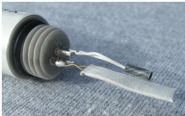
Figur 18: Fugtmåleprobe uden beskyttelseshætte. Øverst: Temperatursensor (gråsort). Nederst: Kapacitiv fugtsensor (inde i hvid filt).
