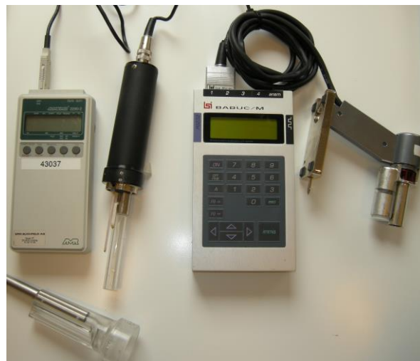
Figur 22: To forskellige psykrometre med tilhørende måleelektronik.
