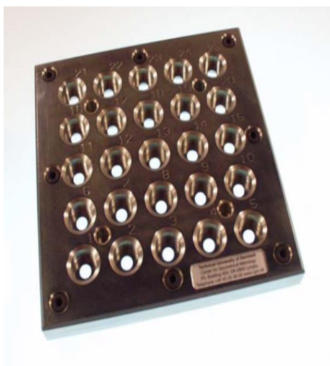
Figur 12: Eksempel på normal i to dimensioner: Hulplade med 25 huller med en centrum-centrum afstand på 20 mm. Denne model er designet af DTU/CGM og kaldes en optomekanisk hulplade da den kan benyttes til både at kalibrere taktile og op-
