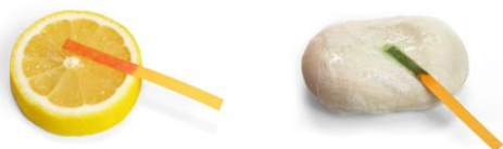
Figur 1: pH indikatorpapir antager rød farve ved kontakt med syre, som f.eks. citronsyre og grøn farve ved kontakt med neutralt stof. Sæbe er normalt lettere basisk, hvilket giver en affedtende virkning, og indikatorpapiret vil da antage en mere blålig farve.
