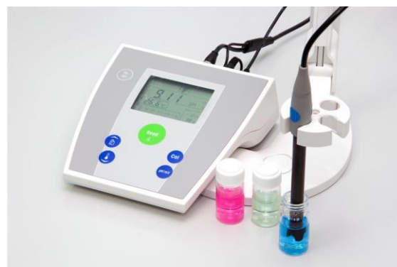
Figur 9: Kommercielt pH-meter. På displayet vises typisk parametre som pH, spænding i mV, følsomhed (eller "Slope") i procent, temperatur i °C, nulpunktsafvigelse (eller "offset") i mV som beskrives i afsnit 3. Desuden kan parametre for gemte bufferopløsninger ofte også vises på displayet.
