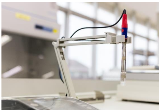
Figur 12: Kombineret elektrodekonfiguration med integrerede glaselektroder og referenceelektroder i en pH-probe.
