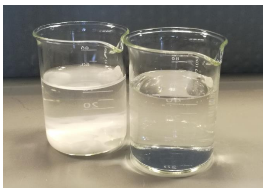
Figur 6 Koncentreret opløsning af salt i højre bægerglas og mættet opløsning i venstre bægerglas med bundfældning) Når stoffets mætningspunkt er nået, falder saltet til bunds.
