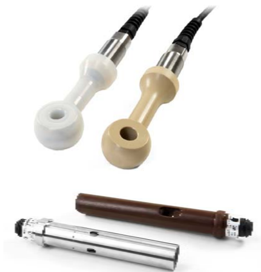
Figur 3: Eksempler på kommercielle ledningsevne sensorer, der fremstilles af firmaet Yokogawa. Øverst ses der to kontaktfrie ledningsevnesensorer i ISC40 familien, der virker ved hjælp af en spole (toroid). Nederst ses en SC42-34 ledningsevnesensor, der er opbygget som en koaksial (cylindrisk) føler. Billederne er givet med tilladelse fra Yokogawa Europe Solutions B.V.
