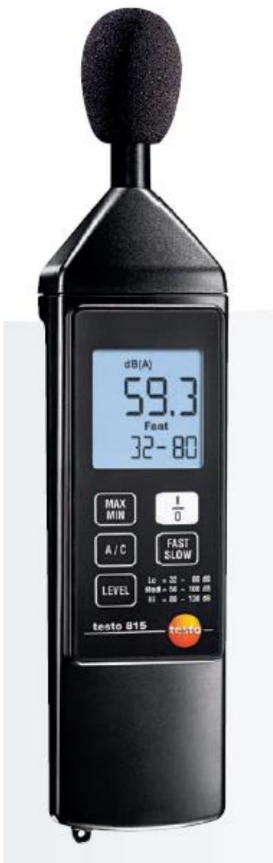
Figur 1: Testo 815 lydtryksmåler. Øverst ses mikrofonen omgivet af en beskyttende skumgummihætte. Størrelsen er højde 26 cm, bredde 6 cm og dybde 4 cm. Kilde: Testo Datablad for Testo 815 er givet ved ref. [2].
