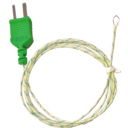
Figur 12: Et type K-termoelement med standardstik. Stik og isolering farvet efter IEC-standarden.
