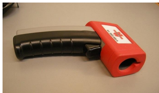
Figur 1: Instrument til måling af temperaturen ved hjælp af stråling. Inde bag det cirkulære hul nederst til højre befinder sig et optisk system, som opfanger temperaturstrålingen. Måleinstrumentet kaldes et strålingstermometer. Det virker ved at man retter den cirkulære åbning mod objektet, hvis temperatur man ønsker at måle. Målingen foretages ved at betjene kontakten i midten af billedet, og temperaturen af objektet aflæses i et display bagerst på den røde krop (displayet kan således ikke ses her).
