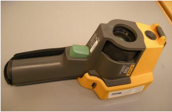
Figur 2: Strålingskamera Ti25 (fabrikat Fluke) til visuel visning af både måleområdet og til punktmåling af overfladetemperaturen. I modsætning til strålingstermometeret vist i Figur 1 er strålingskameraet i stand til også at vise den flade, hvor man i udvalgte punkter kan måle temperaturen ved hjælp af stråling. Kameraet giver altså væsentlig mere information om fladen, man måler på. Til gengæld er prisen væsentlig højere end for strålingstermometeret. På billedet vender kameraets display ned mod bordet og kan således ikke ses på billedet.
