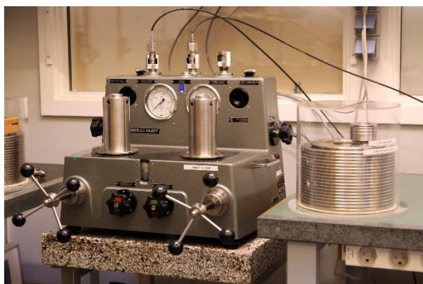
Figur 8 Dødvægtstester til differenstrøks. Lodder opbevares under låg for at sikre højest mulig stabilitet af vægten.
